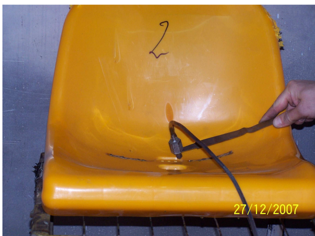
Rys. 6. Zapłon powierzchniowy – czas oddziaływania płomienia (podpalania) 45 s.
