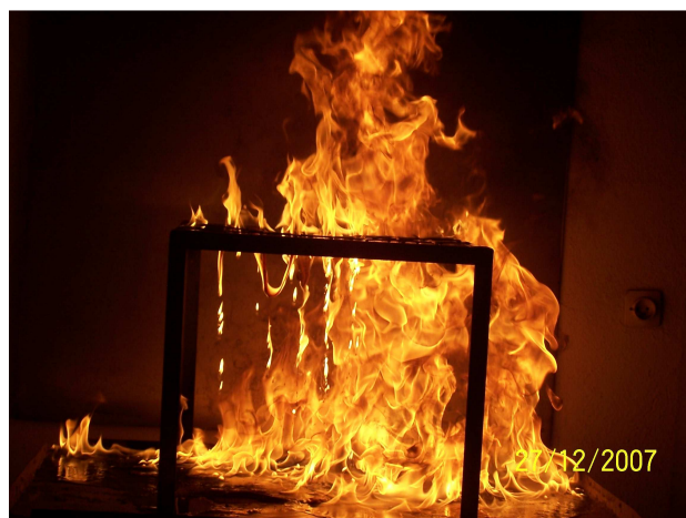
Rys. 5. Intensywne spalanie siedziska z opadem kroplistym po zapłonie krawędziowym
