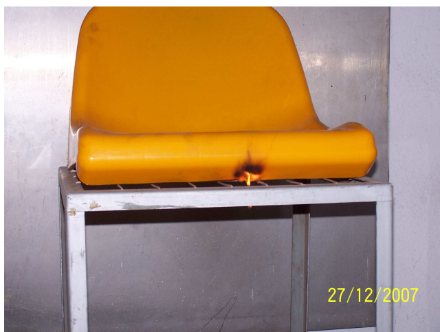
Rys. 4. Zapłon krawędziowy – czas oddziaływania płomienia (podpalania) 15 s.
