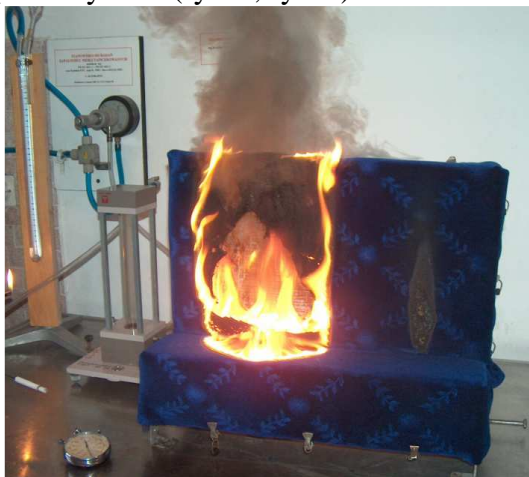
Rys. 2. Spalający się intensywnie zestaw tapicerski po wydłużeniu czasu oddziaływania płomienia do 20 s (zestaw spełnia wymagania norm).
