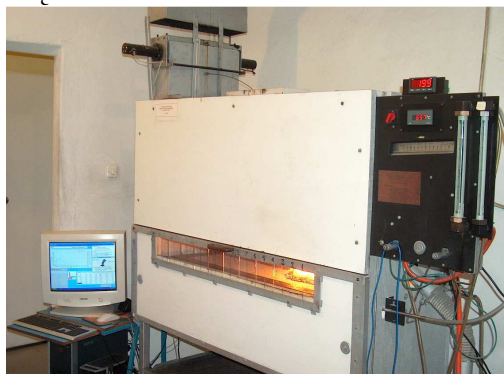
Rys. 17. Stanowisko do badania stopnia palności powierzchniowej materiałów metodą wg PN-EN ISO 9239-1
