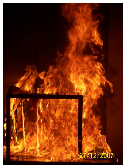
Rys. 7. Intensywne spalanie siedziska z opadem kroplistym po zapłonie powierzchniowym
