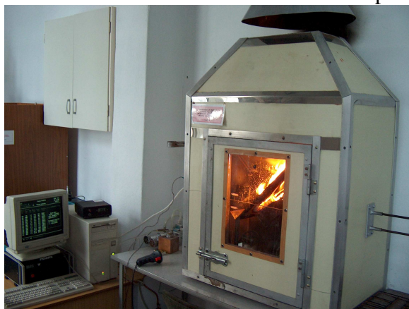
Rys. 9. Stanowisko do badania stopnia palności materiałów budowlanych metodą wg PN-B-02874
