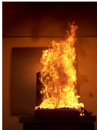
Rys. 3. Spalający się intensywnie fotel tapicerowany po wydłużeniu czasu oddziaływania płomienia do 20 s (fotel spełnia wymagania norm).
