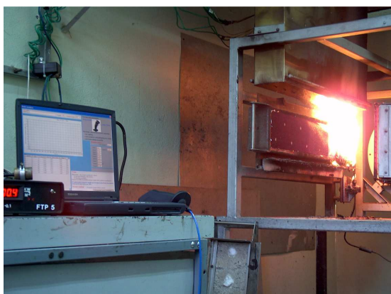
Rys. 15. Stanowisko do badania stopnia palności powierzchniowej materiałów metodą wg Kodeksu FTP część 5
