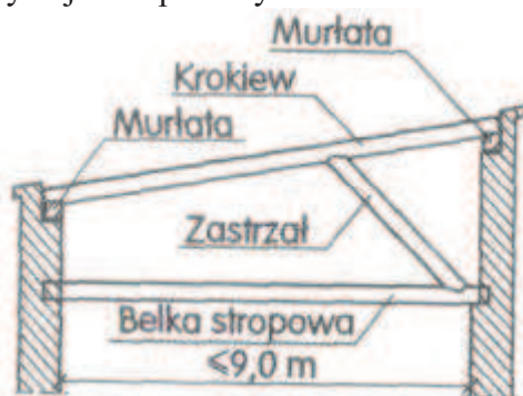
Krokwiowo-zastrzałowy o małym nachyleniu,
