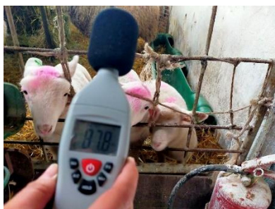
Rys. 1. Pomiar hałasu w owczarni przy użyciu aparatu decybelomierz Voltcraft SL-100
