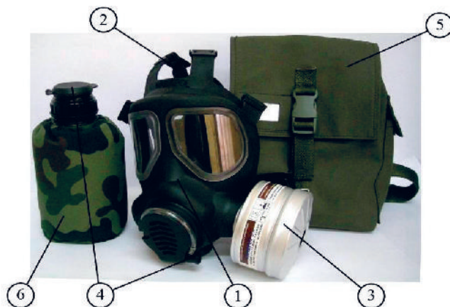
Fot. 16. Filtracyjna maska przeciwgazowa MP-6. 1 - część twarzowa; 2 - nagłowie; 3 - filtropochłaniacz FP-6; 4 - urządzenie do pobierania płynów; 5 - torba nośna, 6 - manierka.
