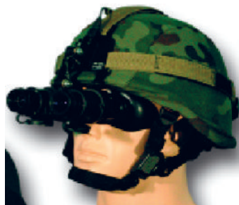
Fot. 9. Gogle noktowizyjne PNL-2AD. Źródło: opracowanie własne.
