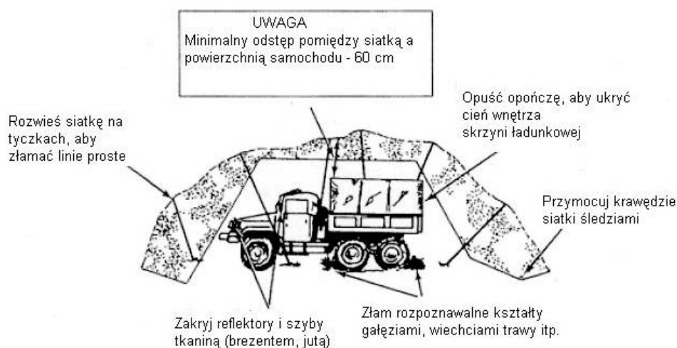
Rys. 42. Sposób maskowania pojazdu za pomocą siatki maskującej (maski).
