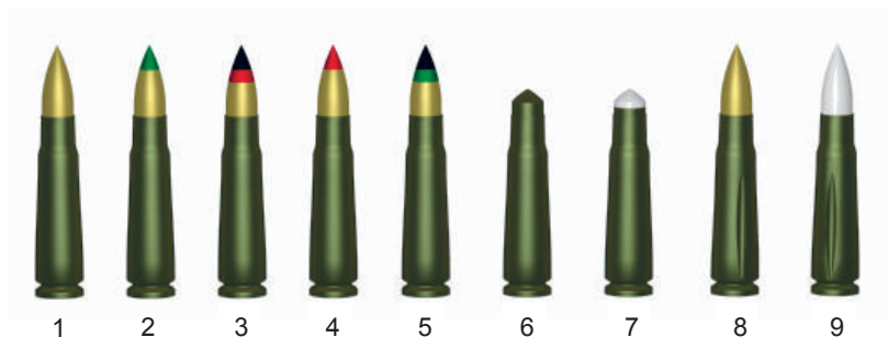
Rys. 35. 7,62 mm naboje wz 1943: 1 – z pociskiem zwykłym PS, 2 – z pociskiem smugowym T- 45, 3 – z pociskiem przeciwpancerno – zapalającym BZ, 4 – z pociskiem zapalającym Z, 5 – z pociskiem o zmniejszonej prędkości US, 6 – nabój ślepy, 7 – nabój miotający UNM, 8 – nabój szkolny, 9 – nabój treningowy.
