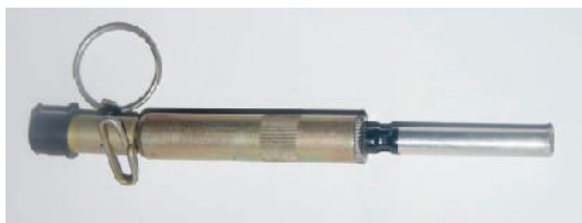
Fot. 107. Zapalnik naciskowy do miny PMD-6 (PMD-6M) składający się z: mechanizmu uderzeniowego MUW-2 oraz zapalnika MD-2.
