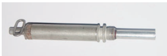
Fot. 106. Zapalnik naciskowy do miny PMD-6 (PMD-6M) składający się z: mechanizmu uderzeniowego MUW oraz zapału MD-5M.
