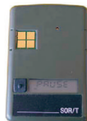
Fot. 22. Dawkomierz indywidualny SOR/T/widok płyty czołowej. Źródło: Wikipedia.
