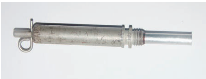
Fot. 112. Zapalnik o działaniu odciągowym do miny POMZ-2M składający się z: mechanizmu uderzeniowego MUW z i zapalu MD-5M.
