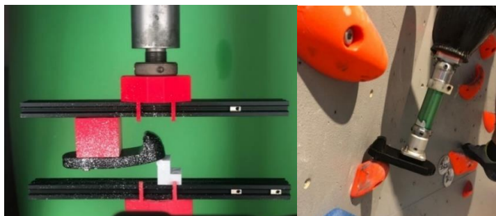
Rys. 1. Prototyp stopy protezowej podczas testów na maszynie wytrzymałościowej (z lewej) oraz na ściance wspinaczkowej (z prawej)
