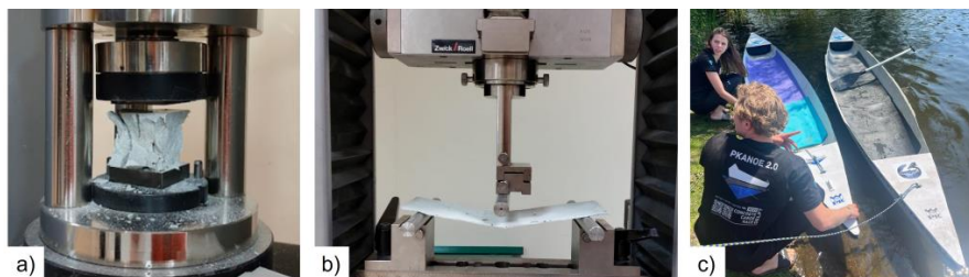
Rys. 1. (a) badania matrycy RPC, (b) badania cienkościennego kompozytu, (c) kadłub łodzi PKanoe 2.0
